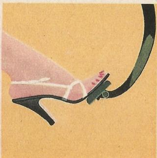
**Hängende Pedale** ermöglichen eine geschlossene Bodenfläche und sind ohne großen Kraftaufwand zu bedienen. Der Innenraum ist vor unerwünschtem Lufteintritt geschützt.
