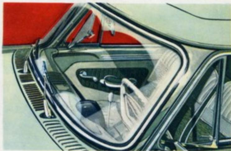
Freier Blick bei jedem Wetter • Die Weitwinkel-Frontscheibe ist sphärisch gewölbt. So halten die großen, parallellaufenden Scheibenwischer von links bis rechts ein sehr breites, sich überschneidendes Blick- und Wischfeld frei. Die Luftzufuhr für Heizung und Lüftung liegt hoch über der Straße direkt vor der Frontscheibe, so daß staub- und abgasfreie Luft in den Innenraum Ihres TAUNUS 17 M gelangt.
