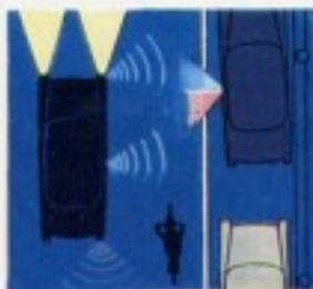
Eine Fahrtrichtungsänderung wird stets durch drei Blinkleuchten gleichzeitig angezeigt.
