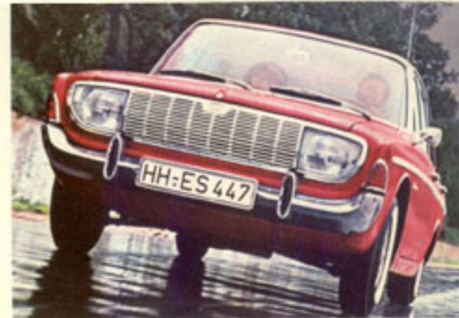
Das neue Breitspur-Fahrwerk sichert überlegene Kurvenfestigkeit. Mit den serienmäßigen, großvolumigen Sportreifen 6,40 S-13 ist die Kraft des Tornado-V6-Motors jederzeit voll einzusetzen.
