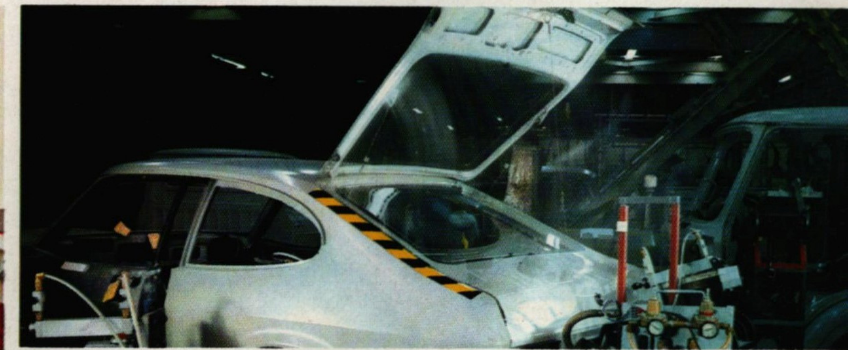
Elektrotauchgrundierung als Rostabwehr ▼
