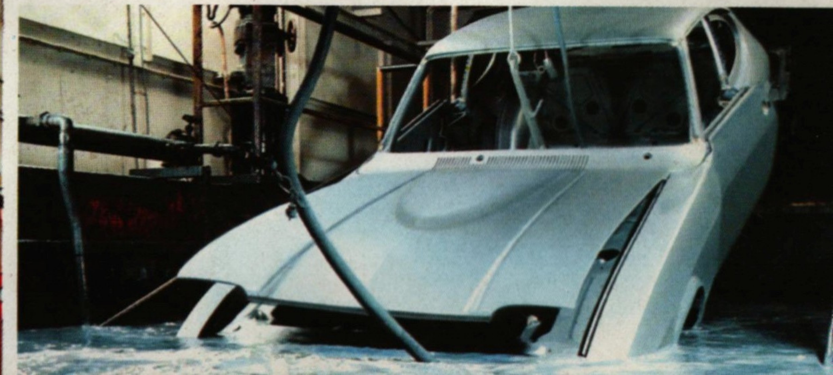
Elektrotauchgrundierung als Rostabwehr ▼
