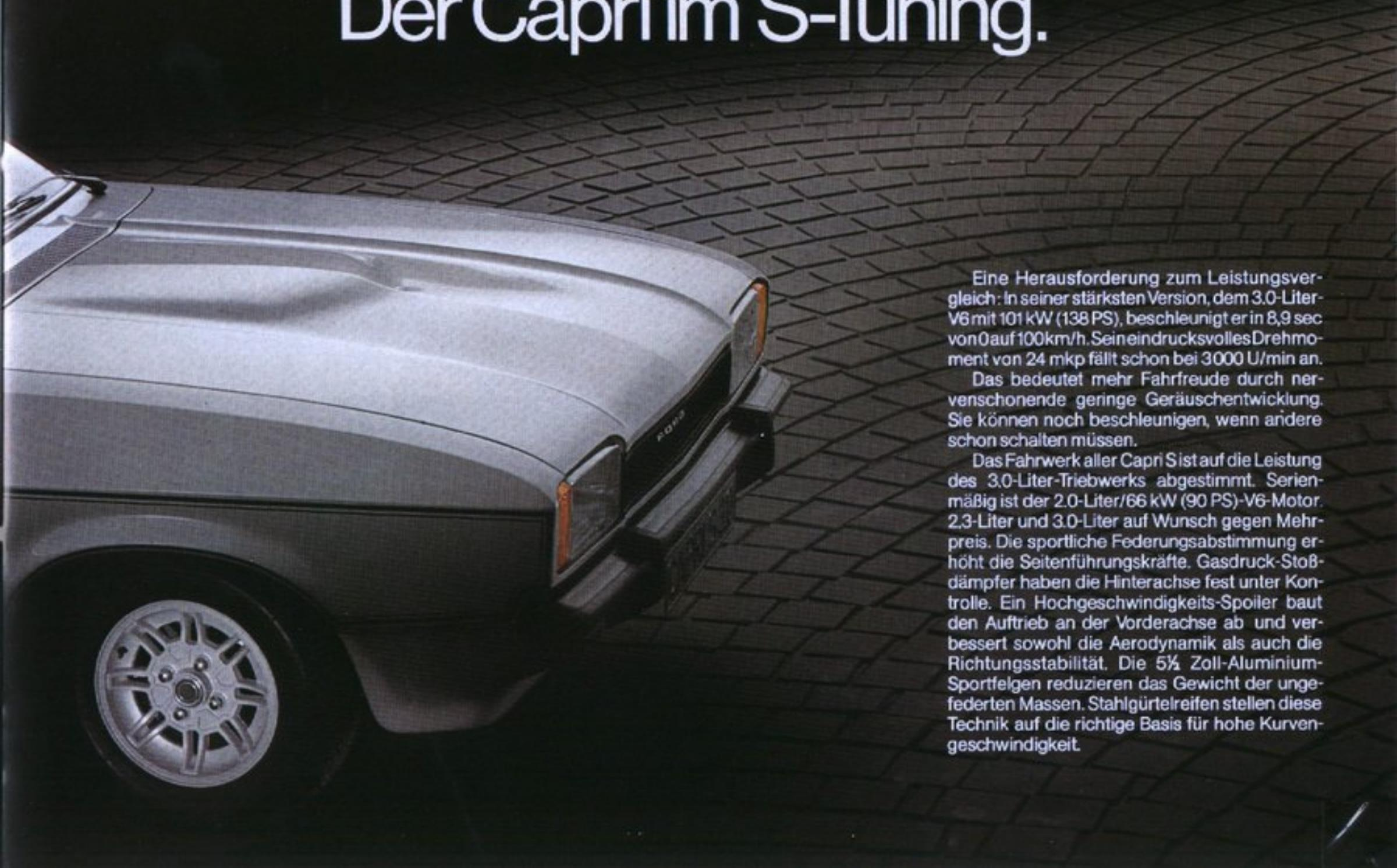
Eine Herausforderung zum Leistungsvergleich: In seiner stärksten Version, dem 3.0-Liter-V6 mit 101 kW (138 PS), beschleunigt er in 8,9 sec von 0 auf 100 km/h. Seineindrucksvolles Drehmoment von 24 m kp fällt schon bei 3000 U/min an.
