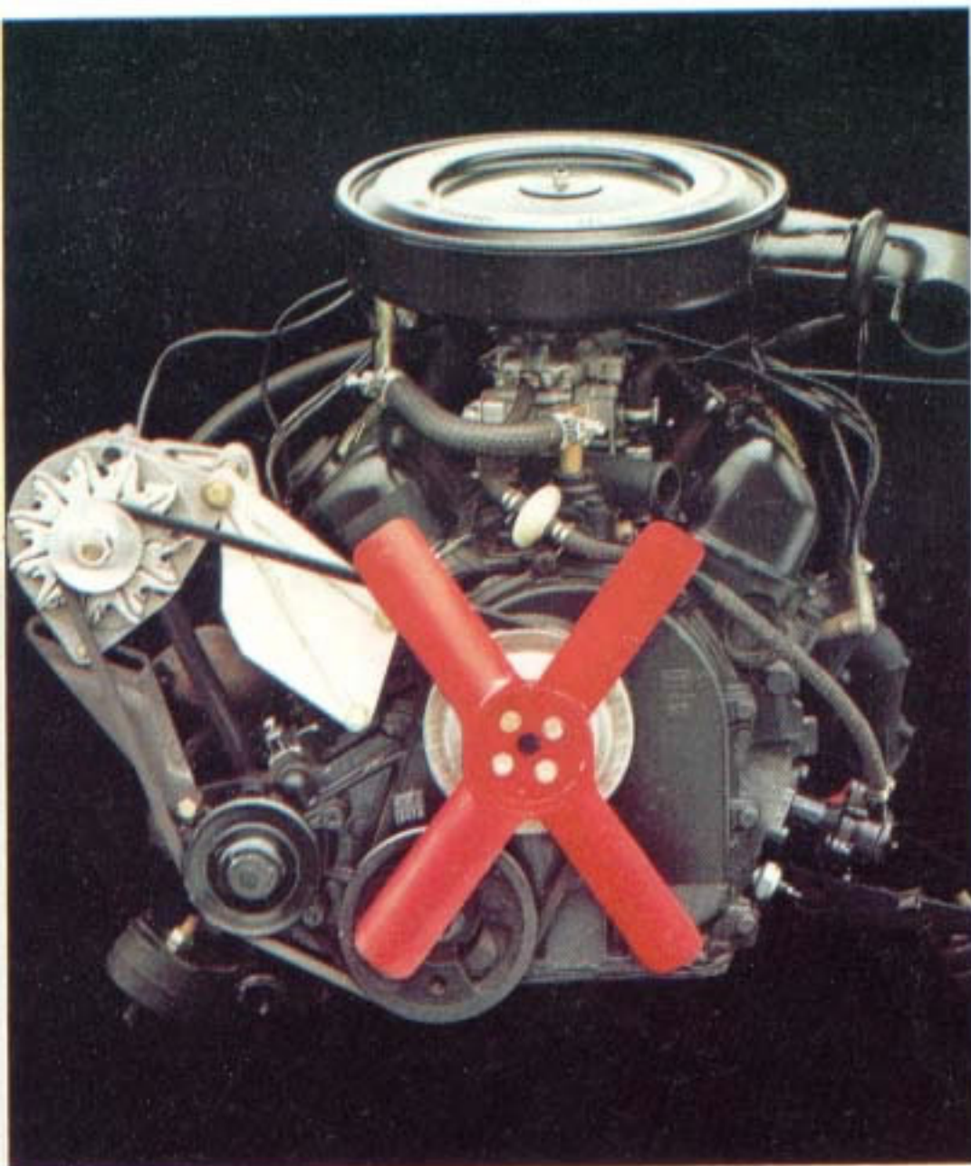
4-cylindret 1,7 liter V-motor, 75 DIN HK ved 5000 o/min, drejningsmoment 13 kgm ved 2500 o/min, kompressionsforhold 9:1.
