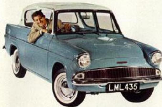
**Moteur** Quatre cylindres en ligne. Alésage, 80,96 mm. Course: 48,4 mm. Cylindrée 997 cc. Taux de compression: 8,9 : 1. Puissance fiscale: 6 cv. Puissance au frein: 41 cv à 5.000 t/mn. Couple, 7,33 mkg/m. à 2.700 t/mn.
