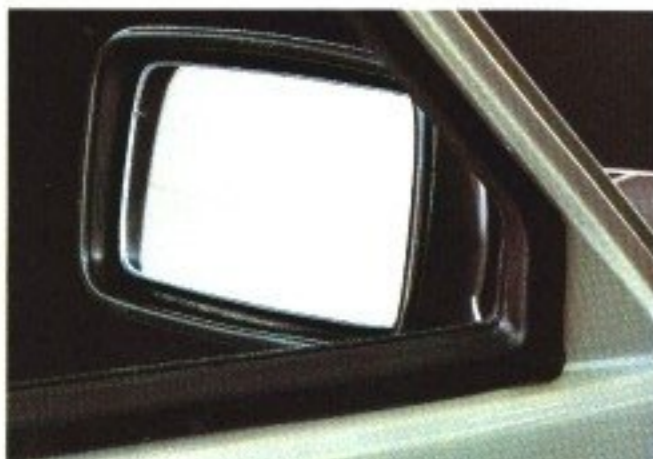
Von innen verstellbarer Außenspiegel – bequemere und raschere Einstellung.
