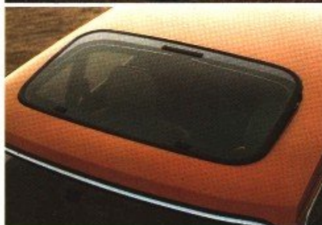
Panoramadach in getöntem Sicherheitsglas – auch hinten hochstellbar.
