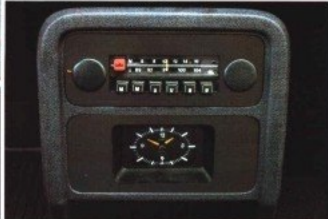
Radio P 22 D in Mittelkonsole mit Zerruhr.
