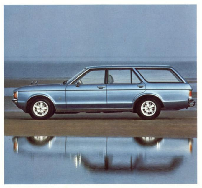
raums von 1,18 m³. Bei umgeklappter Rücksitzlehne erhöht sich das Volumen auf 2,18 m³. Der Granada Turnier kann bis zu 1.900 kg (Ford Anhänger-Paket) ziehen. Besonders angenehm und schonend mit dem vollautomatischen Ford C3-Getriebe mit serienmäßigem Ölkühler.
