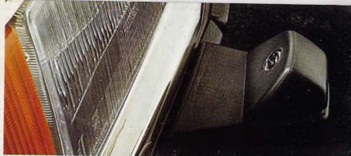
▲ Scheinwerfer-Waschanlage. ▼ Stahlkurbedach, hinten hochstellbar.
