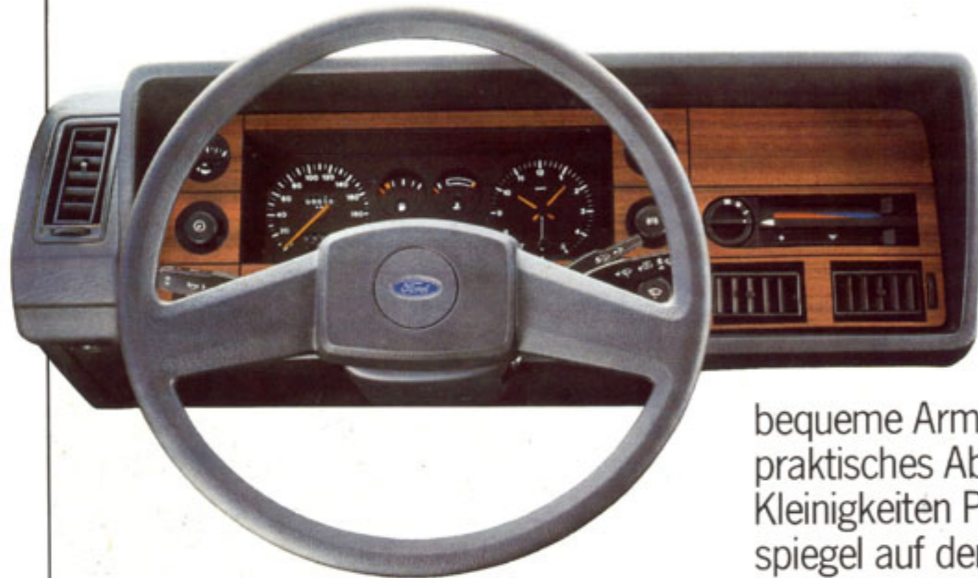
Übersichtlich gestaltetes Instrumentenbrett mit Öldruckmesser und Amperemeter.
