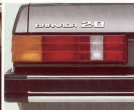
Integrierte Nebelschlußleuchte, Limousine
