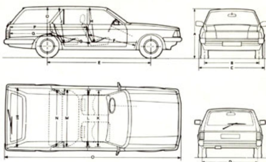
A = Höhe 1416 mm; B = Spur vorn 1515 mm; C = Breite 1800 mm; D = Spur hinten 1532 mm; E = Radstand 2769 mm; F = Beinraum vorn 1055 mm; G = Beinraum hinten 953 mm; H = Kopfraum vorn 969 mm; J = Kopfraum hinten 951 mm; K = Hüfraum vorn 1473 mm; L = Schulterraum vorn 1440 mm; M = Hüfraum hinten 1471 mm; N = Schulterraum hinten 1440 mm; O = Länge über alles je nach Ausstattung 4679 – 4767 mm.
