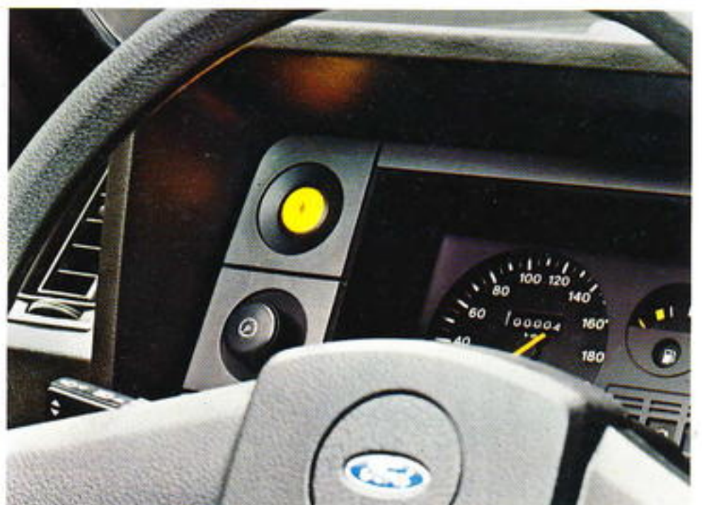
Oversiktlig instrumentpanel med alle viktige hendler på rattstammen.
