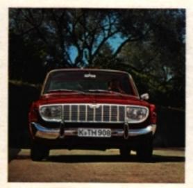
Typisch für den Taunus 17 M: Breitspur. Sie gibt ihm die sichere Straßenlage. Auch in engen Kurven. Zur Breitspur-Sicherheit gehören außerdem: McPherson-Federbeine, große Räder und selbstverständlich Scheibenbremsen vorn.
