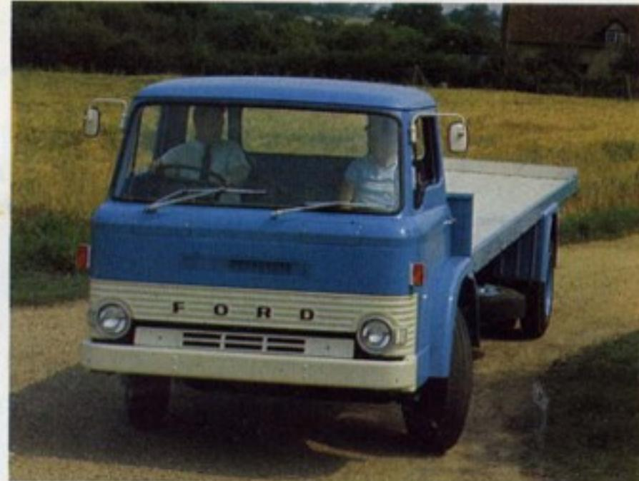
Une nouvelle gamme de camions à cabine ultra-courte basculant à 45° vers l'avant. De 4 990 à 12 700 kg de P.T.R. Grand choix de moteurs Diesel 4 et 6 cylindres. A partir de 23 200 F (t.t.c.). Départ notre entrepôt Val de la Haye.
