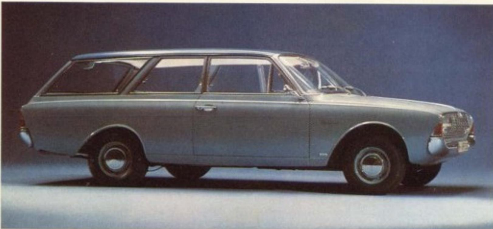
Robuste, vaste, pratique. Idéal pour les familles nombreuses. 6 places. 2,17 m<sup>3</sup> de volume de chargement et 575 kg de charge utile (conducteur compris). Moteur super-carré 4 cylindres en V. 1 700 cm<sup>3</sup>. 10 cv. 145 km/h. Freins à disque assistés, 4 vitesses synchronisées. Existe en version 2 et 4 portes. A partir de 12 200 F (+ t.l.) Départ frontière.
