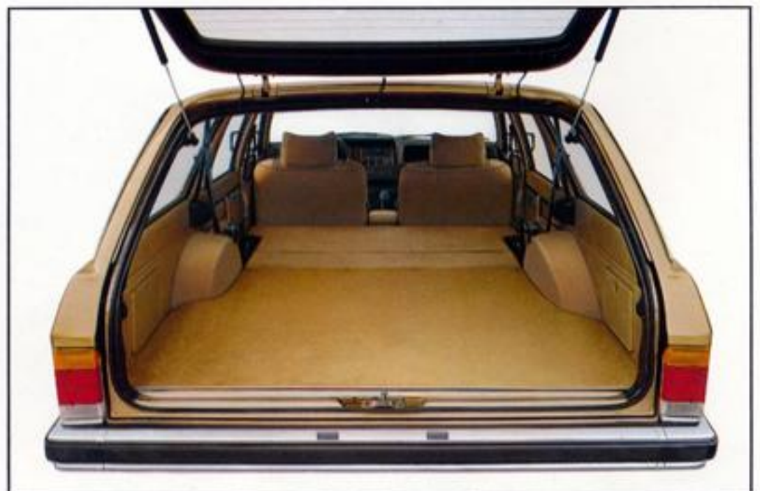
Ford Turnier: Durch Umklappen der Rücksitzlehnen läßt sich der Laderaum wesentlich vergrößern.
