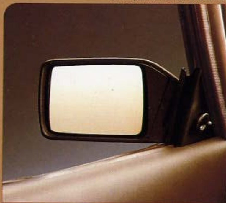
Buitenspiegel met afstandsbediening op het portier van de bestuurder.
