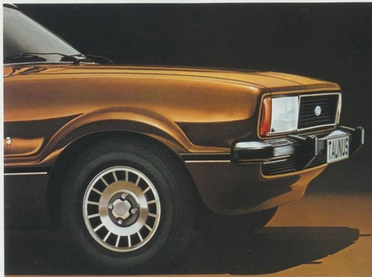
Aluminiumfelgen mit breiten Stahlgürtelreifen
