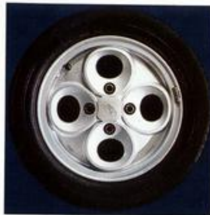
Breite 195/60 HR 14 Niederquerschnittreifen auf 4-Loch-Alu-Sportfelgen als Sonderausstattung (Limousine).
