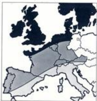
Ein weiteres Ergebnis der intensiven Korrosionsforschung – die Rost-Landkarte. Sie zeigt: Der nördliche Teil der Bundesrepublik liegt in der extrem rostintensiven Zone, der Süden immer noch im Bereich starker Gefährdung.
