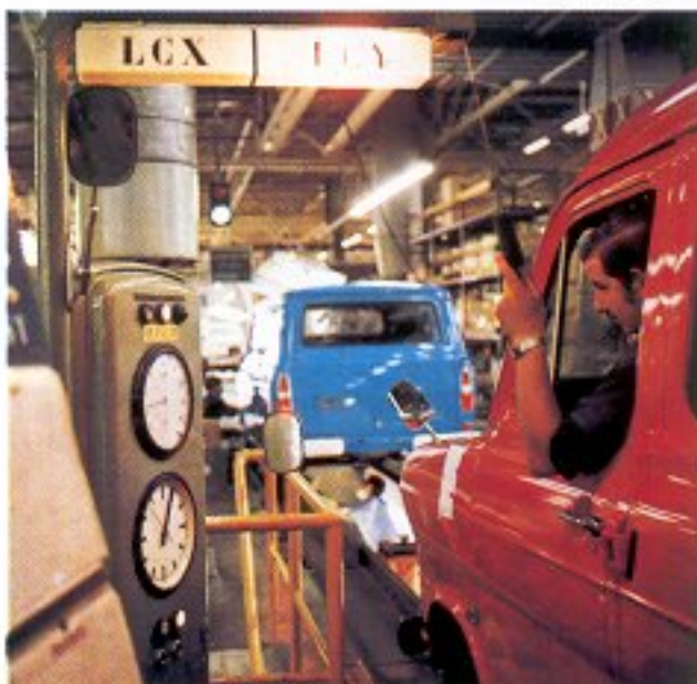
Endkontrolle auf dem Rollprüfstand
