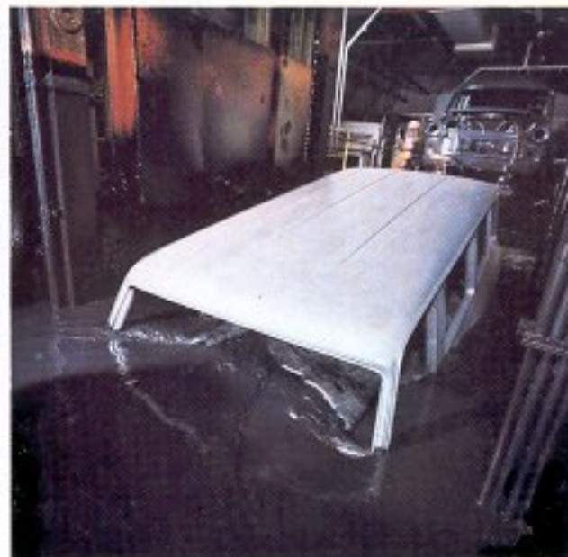
Grundieren im Elektrotauchbad
