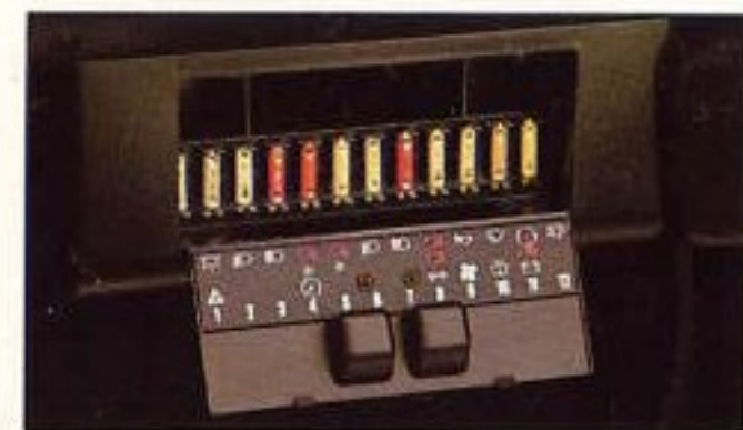
Eines der vielen praktischen Details am Ford Transit: der innenliegende und noch besser zugängliche Sicherungskasten.
