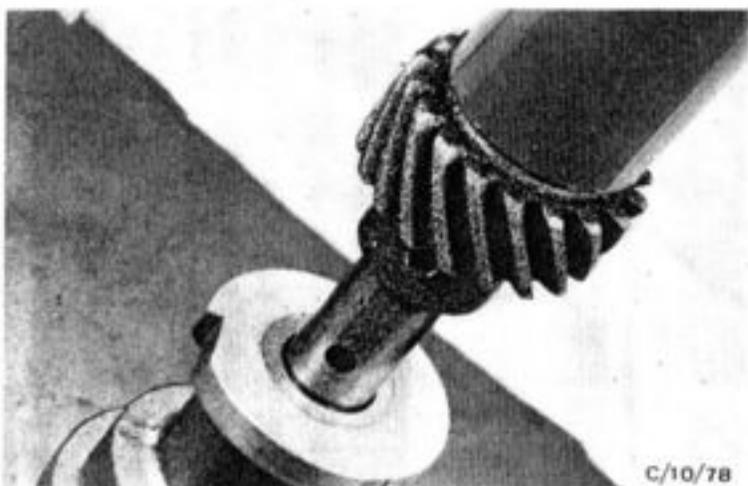
5. Verteilerwelle mit Öl benetzen und in das Gehäuse einführen. Zahnrad aufsetzen und unter der Presse mit einem Rohr (12 mm  $\phi$ , 60 mm lang) aufdrücken, bis die Bohrungen für die Spannhülse fluchten. Spannhülse eintreiben, dabei auf einwandfreie Auflage der Verteilerwelle achten.
