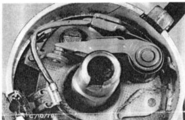
8. Zugstange der Unterdruckdose in den Lagerzapfen einhängen. Unterdruckdose mit der Haltenase im Gehäuserand arretieren. Kondensator mit Anschlußstück montieren und mit dem Haltebügel der Unterdruckdose festklemmen; dabei muß der Kondensator bis zum Anschlag am Gehäuse unten aufsitzen. U-Sicherung der Unterdruckdose anbringen.
