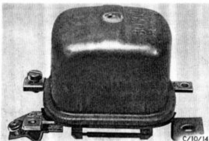
Der Regler enthält keine austauschbaren Verschleißteile und kann in der Werkstatt nicht repariert werden. Die Schutzkappe des Reglers soll nicht entfernt werden, der Garantieanspruch entfällt, wenn dies bei der Überprüfung im Werk festgestellt wird.
