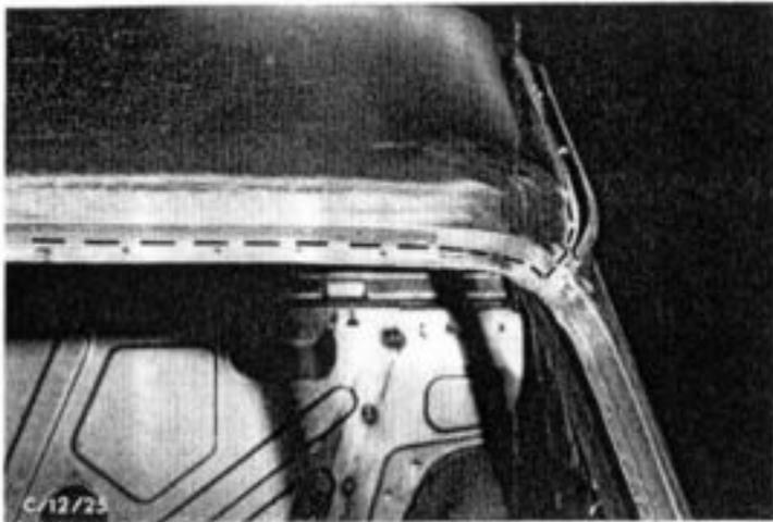
Dachhaut oberhalb der Schweißnaht, an der Scharniersäule (A-Säule) seitlich innen an der Regenrinne und oberhalb des Punktsteges an der Frontfensteröffnung autogen trennen.
