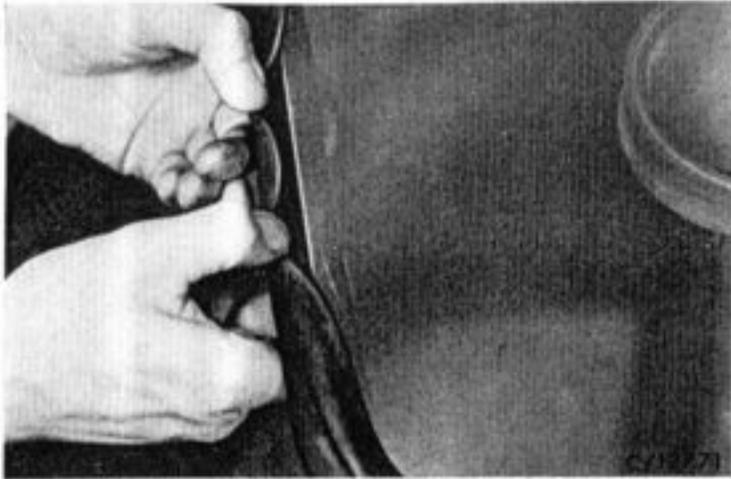
Dichtlippe mit einem Holzspan außen von der Karosse lösen und Rückwandfenster herausdrücken.
