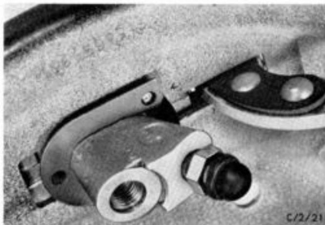
4. Halteklammer und Staubmanschette vom Radzylinder entfernen. Innenteile vorsichtig mit Druckluft aus dem Zylinder drücken. Sitz der Staubmanschette am Zylinder mit einer Drahtbürste reinigen. Zylinder und Kolben mit Spiritus reinigen und anschließend mit wasserfreier, gefilterter Druckluft durchblasen.
