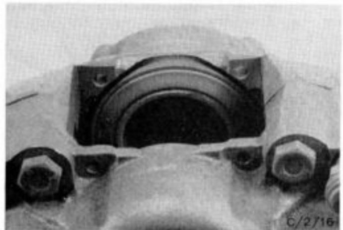
3. Anlageflächen an Achsschenkel und Bremsattel säubern und kontrollieren. Bremsattel mit neuem Sicherungsblech am Achsschenkel befestigen. Schrauben mit vorgeschriebenem Drehmoment festziehen und sichern.
