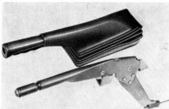
Nach dem Einbau Handbremsseil am Schwinghebel so weit nachstellen, bis der Hebel etwas vom Anschlag abgehoben hat. Jetzt muß das Seil zurückgestellt werden, bis der Schwinghebel gerade am Anschlag anliegt.
