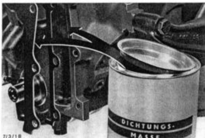
12. Zylinderblockstirnseite am äußeren Umfang sowie die Rückseite der vorderen Zwischenplatte mit Dichtmasse bestreichen, Dichtung auflegen und Zwischenplatte zunächst nur handfest an den Zylinderblock montieren. Zur Führung 2 weitere Schrauben in die unteren Bohrungen der Zwischenplatte schrauben und nach dem Festziehen der Zwischenplatte wieder entfernen.
