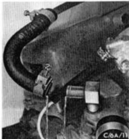
Alle Kabel-, Schlauch- und Seilzugverbindungen einschließlich Auspuffrohre am Motor befestigen. Luftleitblech und Kühler einbauen.
