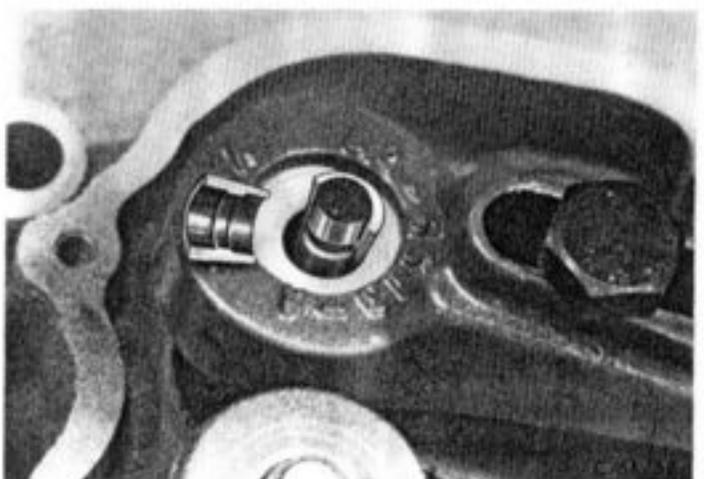
Werkzeuge GK 6513-A und -B am Zylinderkopf anbringen. Federteller herunterdrücken und beide Ventilsfederkeile einsetzen.
